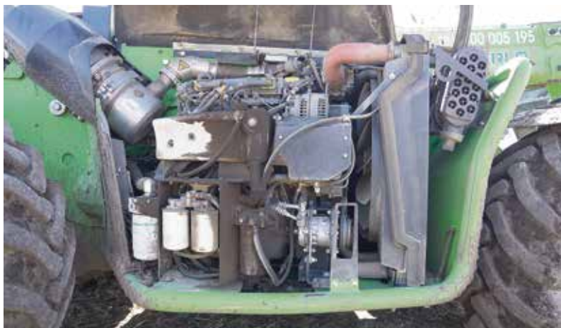
W ładowarce silnik ustawiono wzdłużnie pod niewielkim kątem. Takie położenie związane jest z wyposażeniem maszyny w tylny wałek, który napędzany jest mechanicznie bezpośrednio od jednostki napędowej
