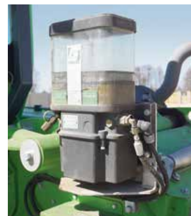
Maszyna wyposażona jest w automatyczny system smarowania holenderskiej marki Groeneveld, dzięki której ograniczono do minimum czynności obsługi
