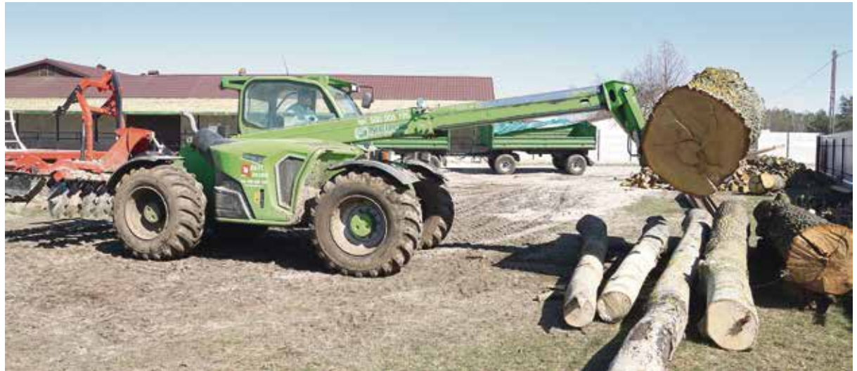
Ładowarka czasami jest wykorzystywana do pracy w tartaku. Na zdjęciu dźwiga kłodę ważącą 3325 kg
