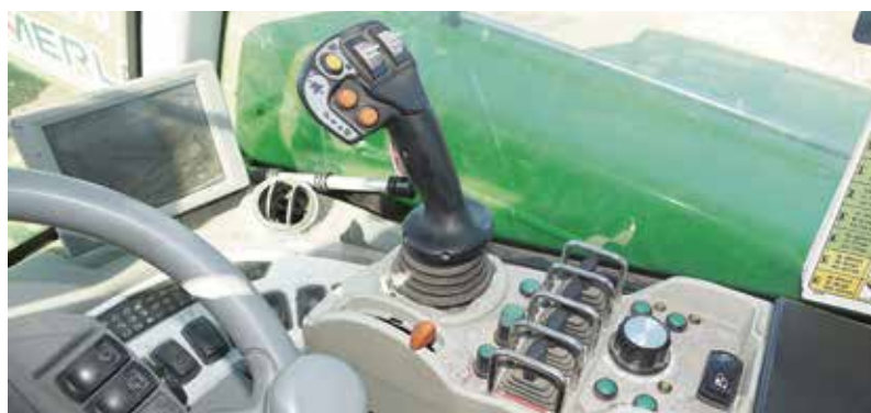
W Merlo Multifarmer 40.7 CS można jednocześnie wykonywać trzy ruchy wysięgnika (podnoszenie, wysuwanie, obrót). Wszystkie realizowane jest dżojstikiem zamontowanym w kabinie
