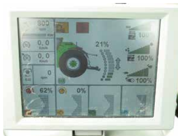
Wyświetlacz przy kierownicy (na zdjęciu z lewej) wskazuje m.in. prędkość jazdy, obroty silnika, przebieg czy ilość spalane paliwa. Na monitorze (na zdjęciu z prawej) prezentowana jest praca systemu dynamicznej kontroli obciążenia oraz wyświetlane są funkcje ciągnika rolniczego dotyczące tylnego podnośnika, WOM-u czy gniazd hydraulicznych. Na tym monitorze można również odczytać dane dotyczące wagi podnoszonego ładunku
