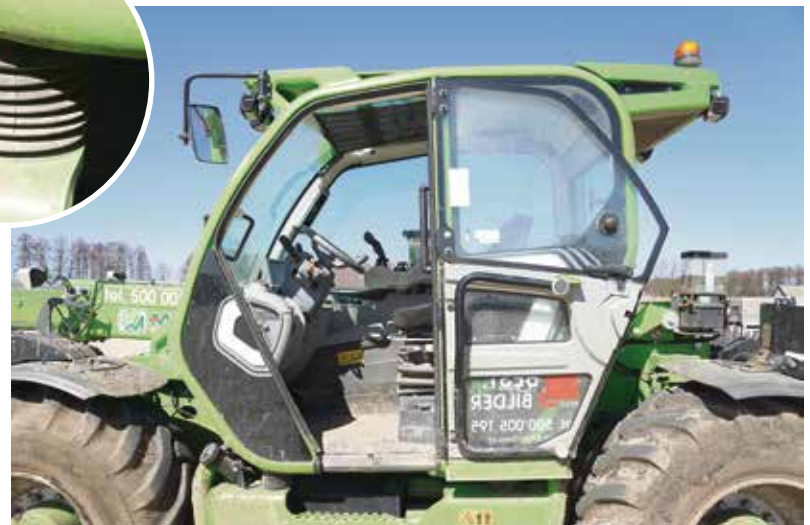
Merlo posiada amortyzowaną hydropneumatyczne kabinę (oznaczenie CS w nazwie), gdzie maksymalny skok zawieszenia góra-dół wynosi 11 cm
