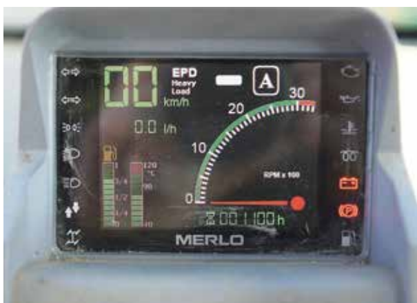
Wyświetlacz przy kierownicy (na zdjęciu z lewej) wskazuje m.in. prędkość jazdy, obroty silnika, przebieg czy ilość spalane paliwa. Na monitorze (na zdjęciu z prawej) prezentowana jest praca systemu dynamicznej kontroli obciążenia oraz wyświetlane są funkcje ciągnika rolniczego dotyczące tylnego podnośnika, WOM-u czy gniazd hydraulicznych. Na tym monitorze można również odczytać dane dotyczące wagi podnoszonego ładunku
